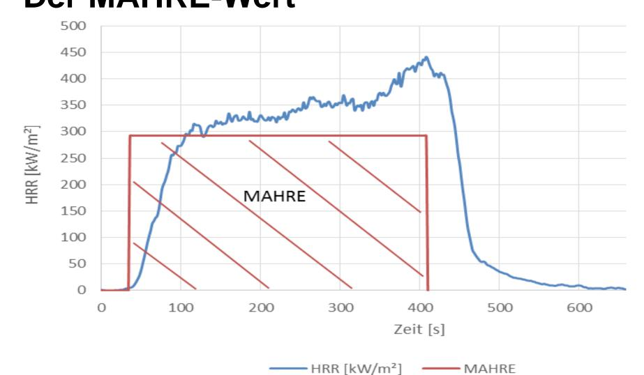
Ein wichtiges Ergebnis des Cone Calorimeters ist der MAHRE-Wert, der die durchschnittliche Wärmefreisetzungsrate vom Zündzeitpunkt bis zum HRR-Peak angibt.
